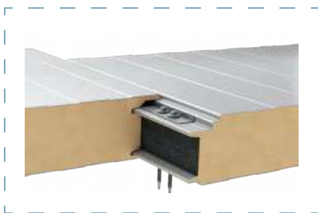
Schemat łączenia płyt
